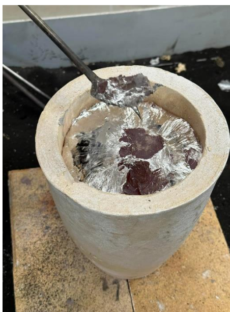
Obr. 1 Odstranění oxidové vrstvy před litím
