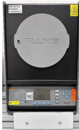
Obr. 2 Kalibrátor s plochou doskou pri pohľade infračerveným teplomerom.
