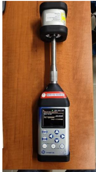
Fig. 2 Kalibrace zvukoměru SVANTEK 979 akustickým kalibrátorem SV 3
