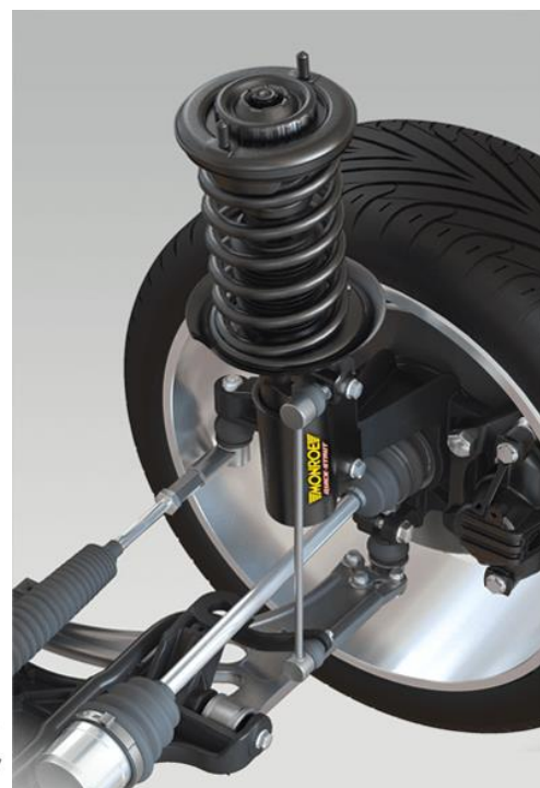
Obr. 1. Konstrukce umístění tlumiče typu McPherson [2w, 3w]
